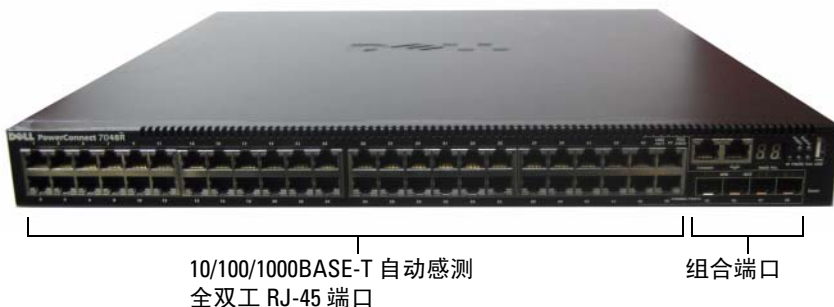
图 1-6. PowerConnect 7048R, 具有 48 个 10/100/1000BASE-T 端口
